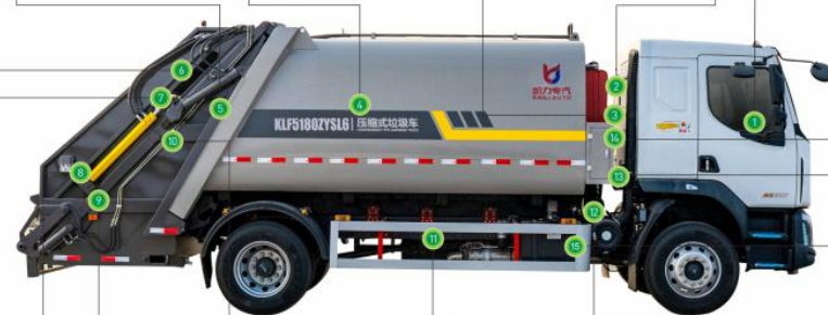
4 弧形箱体 关键部位采用高强度钢，屈服强度是普通钢材的2.5倍以上，在保证车辆轻量化化的同时，箱体强度更高。圆弧一次成型，抗冲击更强，装卸垃圾更流畅，增大车辆有效容积。表面三道涂漆长久不褪色。
